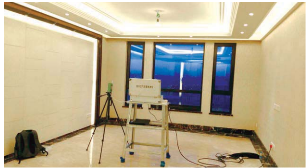
▲ 室内空气检测
